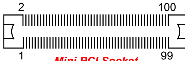
Mini PCI Socket pin orientation
